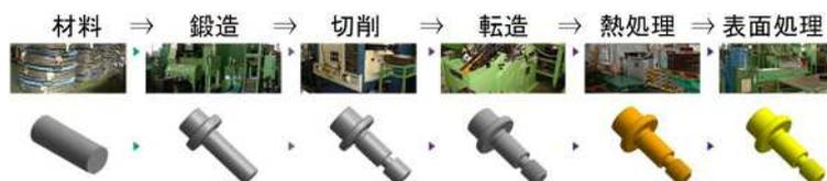
図9 工場見学と製造工程
