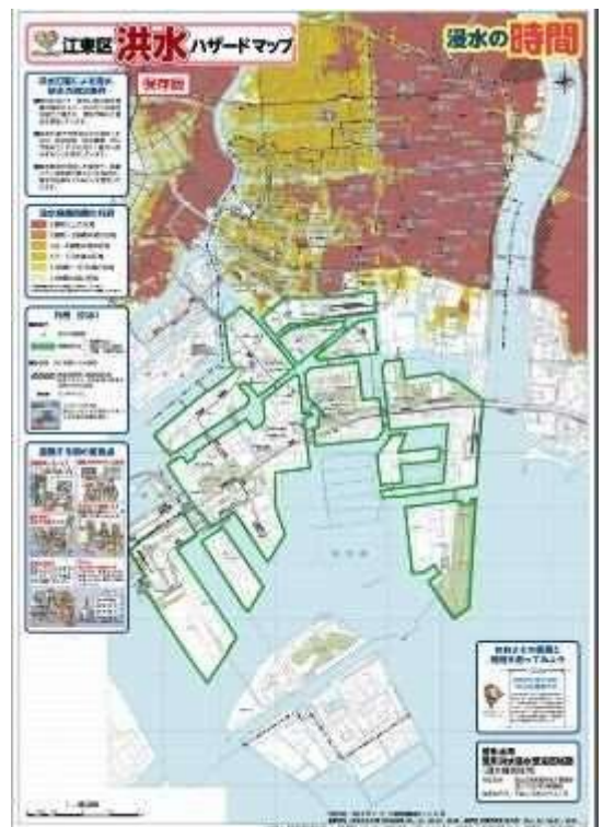
図-2 洪水(浸水時間)ハザードマップ例 6)
