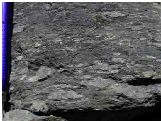
写真-1 泥質部優勢混在岩 泥質（黒色）基質中に砂質部（灰色）が とりこまれている。
