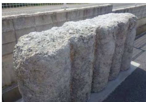
図-2.地下ダム止水壁の模型
